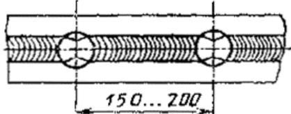
1.8. Если границы сварного шва или наплавленного металла не могут быть установлены осмотром без дополнительной обработки, то торцы вырезанных участков и поверхность просверленных отверстий должны быть отшлифованы и протравлены.
