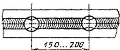
1.8. Если границы сварного шва или наплавленного металла не могут быть установлены осмотром без дополнительной обработки, то торцы вырезанных участков и поверхность просверленных отверстий должны быть отшлифованы и протравлены.
