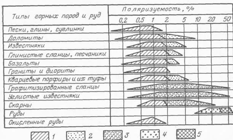
Рис. 6. Сводная диаграмма поляризуемостей пород и руд (по В. А. Комарову):
