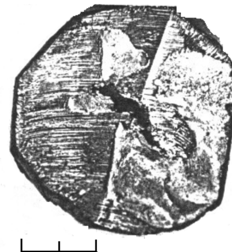
Рис. 2.9. Трещины в кованных заготовках
