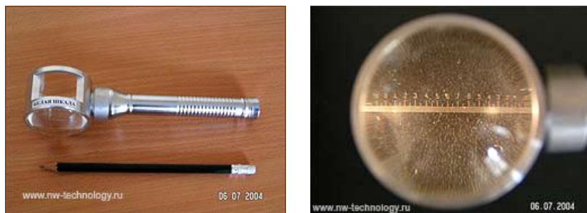
Рис. 7. Лупа с 10-кратным измерением, с подсветкой, с белой измерительной шкалой
