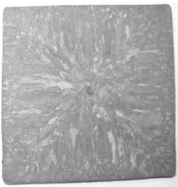
Рис. 51. Травленные макро темплеты с развитой столбчатой структурой.
