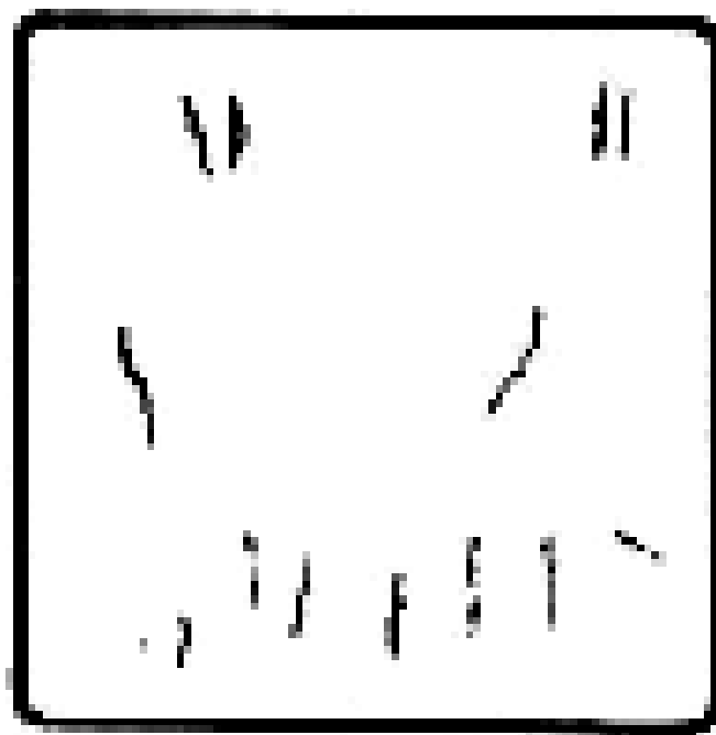
Рис. 44. Внутренние трещины вследствие неравномерного охлаждения заготовки на воздухе, схема.
