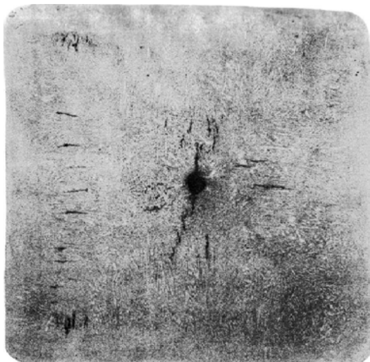
Рис. 41. Травленный темплет с дефектом ЛПТпр, ЛПТос (см. п. 4.1.3. ) и центральной пористостью (см. п. 4.3.)
