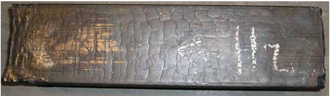
Рис. 55. Извлеченный «чулок» из кристаллизатора после прорыва подвисяния из-за деформированной гильзы
