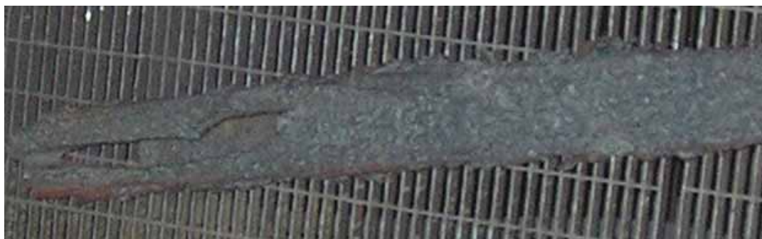
Рис. 54. «Хвост» ручья после прорыва охлаждения в ЗВО по продольной трещине
