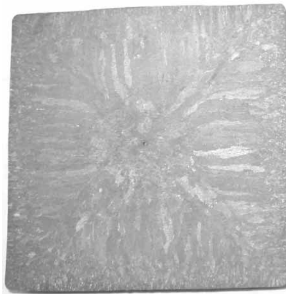
Рис. 52. Травленный макро темплет с асимметрией кристаллов заготовки
